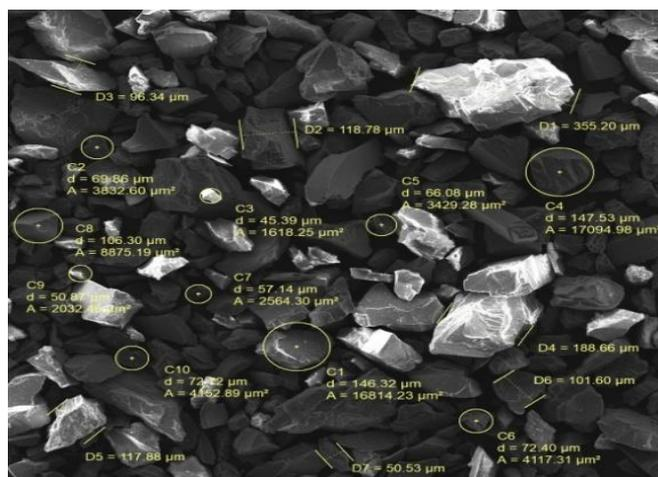
Рис.7 Микрофотография компонента полевого шпата.
