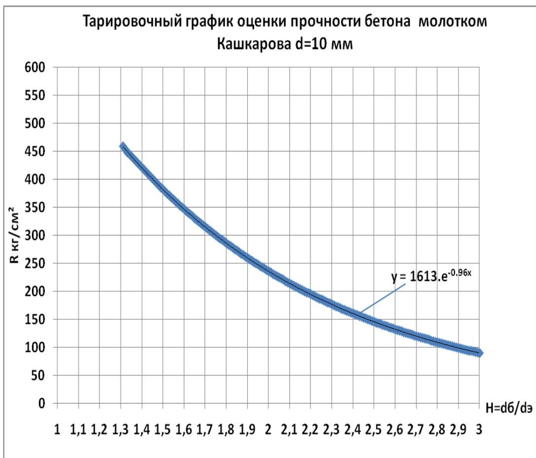
Рис.3. Тарировочный график оценки прочности бетона молотком Кашкарова с диаметром эталонного стрежня  $d=10$  мм
