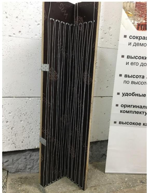
Рис. 2. Расположение греющего провода на внутренней поверхности опалубки
