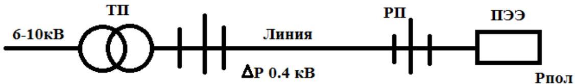
Рис.1. Упрощенная схема электроснабжения рассредоточенных объектов
