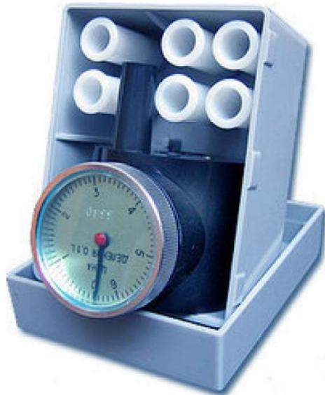
*Рис. 1. Общий вид портативного спирометра ССП*
