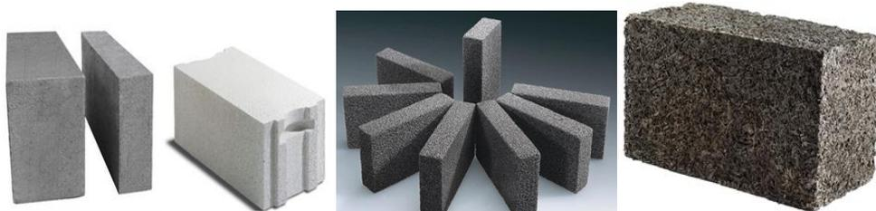
Рис. 2. Ячеистые бетоны и силикаты
