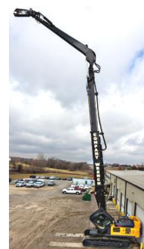
Рис.4 – Мобильные гидроножницы для сноса высотных зданий и сооружений
