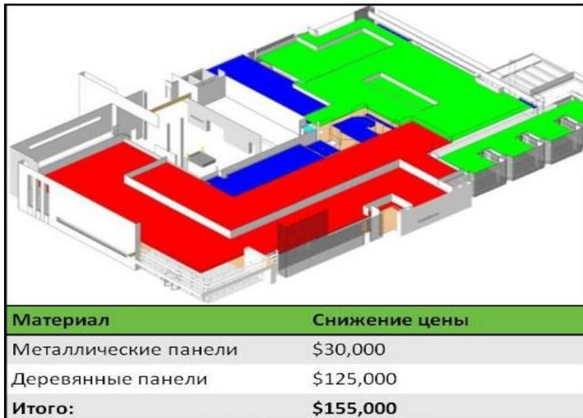
*Рис. 3. Пример использования BIM для точного определения объемов и материалов для тендера. Располагая моделью, строители смогли с высокой точностью оценить стоимость возводимого объекта и дать на тендер такое предложение, которое точно учитывало потребности, оставляло этот заказ рентабельным для строительной компании и сэкономило средства для Заказчика.*
