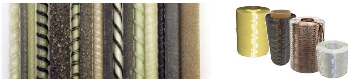
Рис.1. Композитные арматуры (а) изготовленные на основе углеродных, арамидных, стеклянных и базальтовых непрерывных волокон (б)
