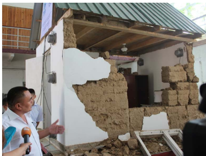
Рис. 1. Общий вид модели дома «сокмо» после эксперимента на сейсмоплатформе КГУСТА им. Н. Исанова.
