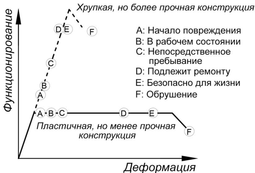
Рисунок 3. Иллюстрация возможных уровней функционирования (стойкости) для пластичных и хрупких конструкций (Руководство Международной федерации по железобетону, 2003)
