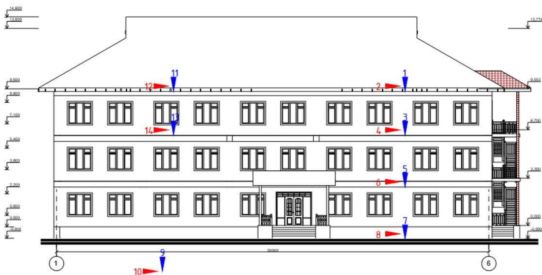
Рис. 7 – Схема размещения датчиков на здании.
