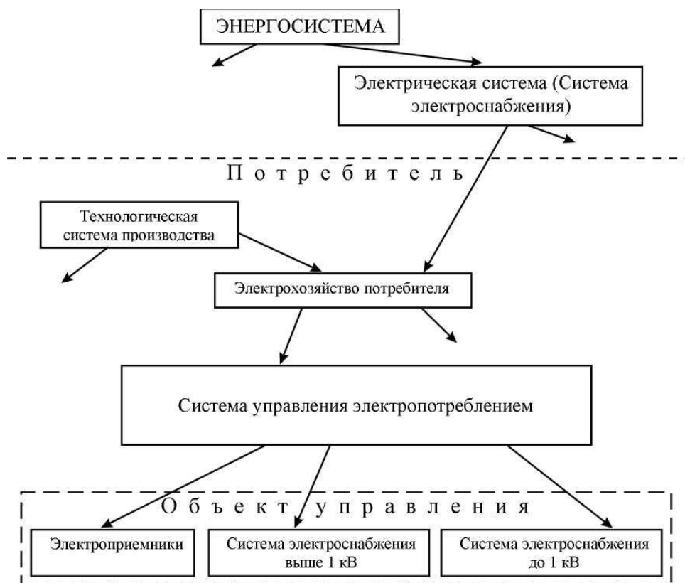
Рис. 1. Иерархическая связь системы управления электропотреблением в электрохозяйстве потребителя с системами высшего уровня
