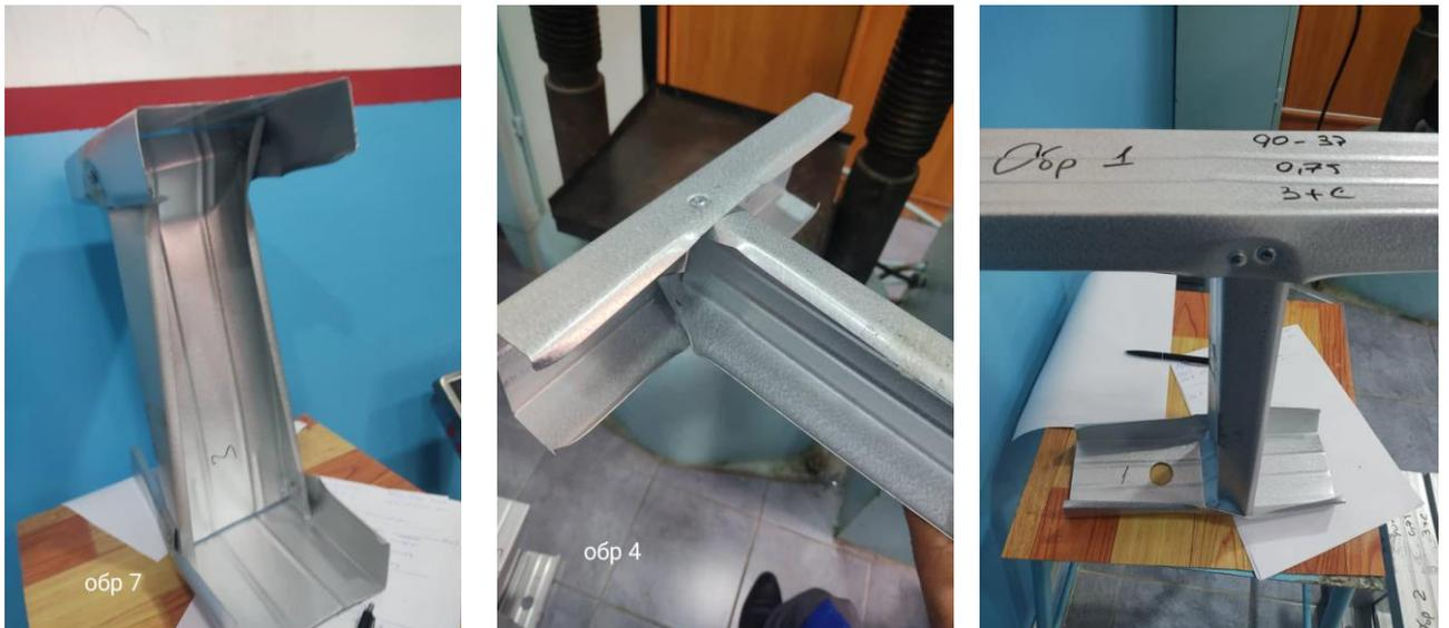
Рисунок 5 – Деформация и потеря устойчивости стойки
