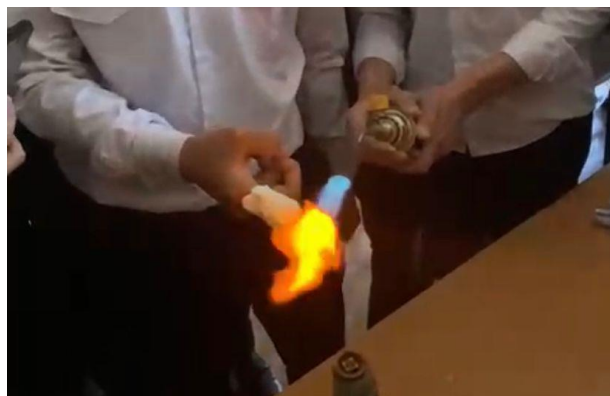
Рис.2 Старлайт покрытый пальчик, температура 1300 °С.
