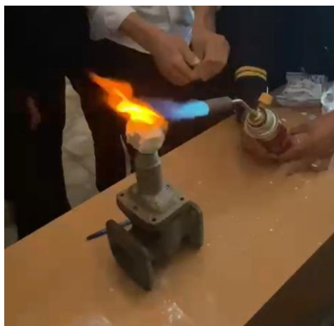
Рис.1 Старлайт покрытый яйцо выдерживает температуру 1300 °С
